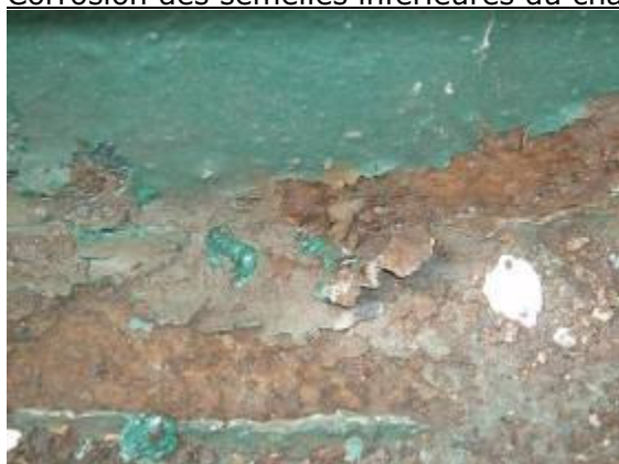
Corrosion des semelles inférieures du châssis
